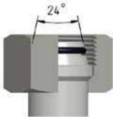
Dichtkegelanschlüsse DKOL/DKOS 24° mit O-Ring und Überwurfmutter Raccordement DKOL/DKOS 24° Ecrou tournant & joint torique
